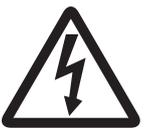
Знак молнии с наконечником в виде стрелы, заключенный в равносторонний треугольник, предназначен для предупреждения пользователей о наличии внутри корпуса устройства неизолированного «опасного напряжения», которое может быть достаточно велико для возникновения риска поражения электрическим током.
