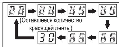
Каждый раз при выгрузке или загрузке картриджа с красящей лентой счетчик оставшегося количества красящей ленты на индикаторе состояния устанавливается на начальное значение. Информация об индикации ошибок приведена на странице 46.
